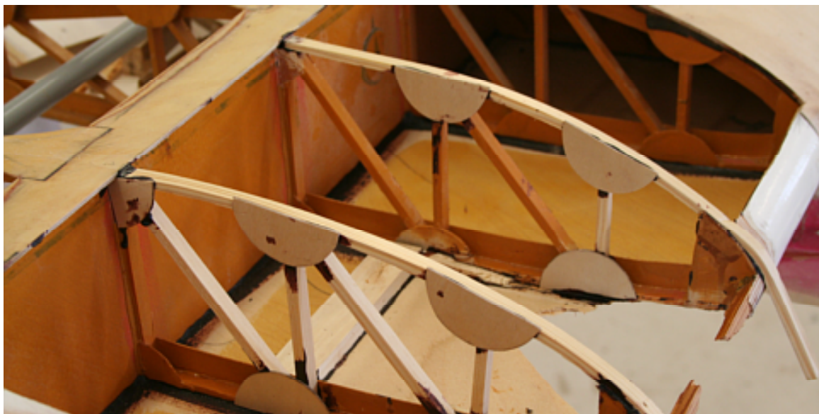
Bild 7: Innenleben einer Holztragfläche
